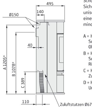
Der Mindestabstand zwischen Kaminofenöffnung und einem brennbaren Gebäudeteil oder Einrichtungsgegenständen beträgt 1 m.
