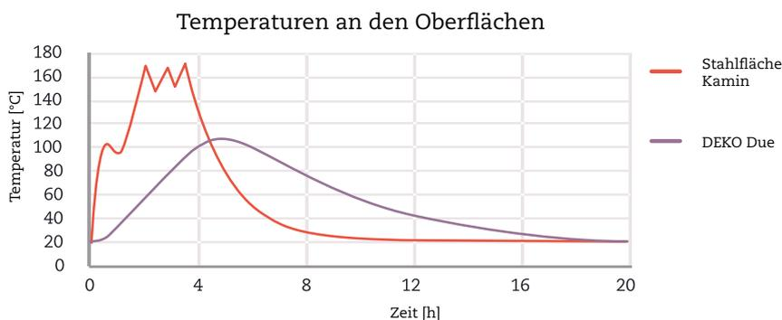
Bei der DEKO Due sorgt der Doppelmantel aus Mammutti-Speckstein für gleichmäßige, auch nach Erlöschen der Flamme bis zu 12 Stunden lang anhaltende Komfortwärme.
